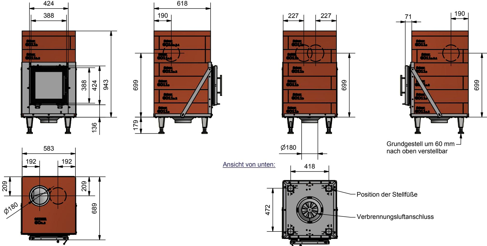
Alle Höhenangaben gelten bei einer Mörtelfugenstärke von 3 mm, einer Fasermattenstärke von 3 mm (im zusammengepressten Zustand) und vollständig nach unten geschraubtem Grundgestell.
